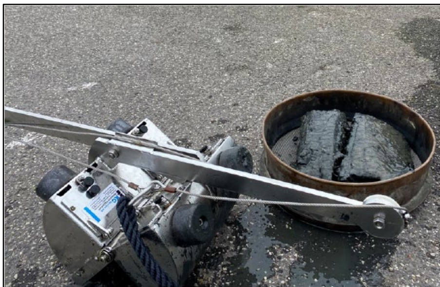
Figur 2.5. Håndholdt Van Veen grab og sigte anvendt i fbm. indsamling af bundprøver.
