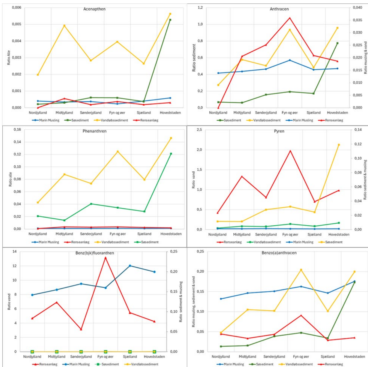
Figur 4.10. Ratio (risikokvotienter) af PAH-mediankoncentrationer vs. MKK-værdier for biota, sediment og vandprøver målt i prøver fra marine områder, vandløb, søer og spildevand, udløb. Bemærk der er to skalaer for Y-aksen i de tilfælde, hvor der er for stor forskel på ratioerne for de forskellige matricer til at de kan afbildes på en skala. Ratio vand referer til spildevand, udløb.
