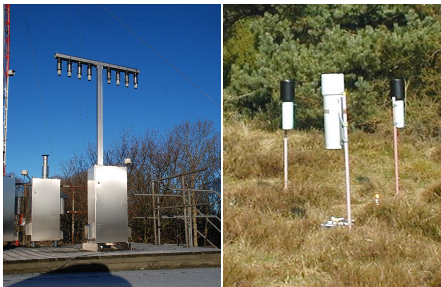
Figur 1.2. Eksempler på udstyr på målestationerne. Til venstre: Filterpackopsamler til opsamling af luftprøver. Opsamleren består af en filterholder (for enden af hver af de otte arme) med tre filtre, som luften suges igennem, hvorved partikler og gasser opsamles og separeres. Til højre: Nedbørsopsamlere til bestemmelse af bulkdeposition (dvs. våddeposition plus et lille bidrag fra tørdeposition). Nedbørsopsamlerne består af et stativ, en tragte og en opsamlingsflaske monteret forinden på tragten. Opsamlingsflasken er placeret i rør for at beskytte mod sollys.
