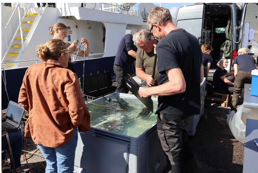
Figur 2.1. Måling af salinitet og temperatur med CTD-sonder på kajen ved Svendborg d. 8/9-2025. Foto: Teis Boderskov
