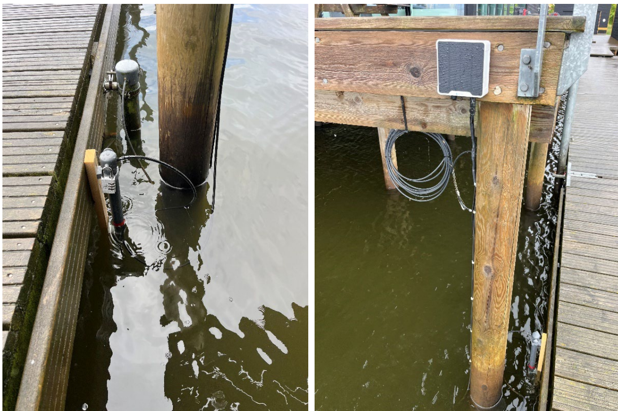
Figur 3.1. Billeder af multisonde og metabolismestationsplacering. Til højre ses metabolismestations datalogger, som forsynes med strøm fra solpanel.
