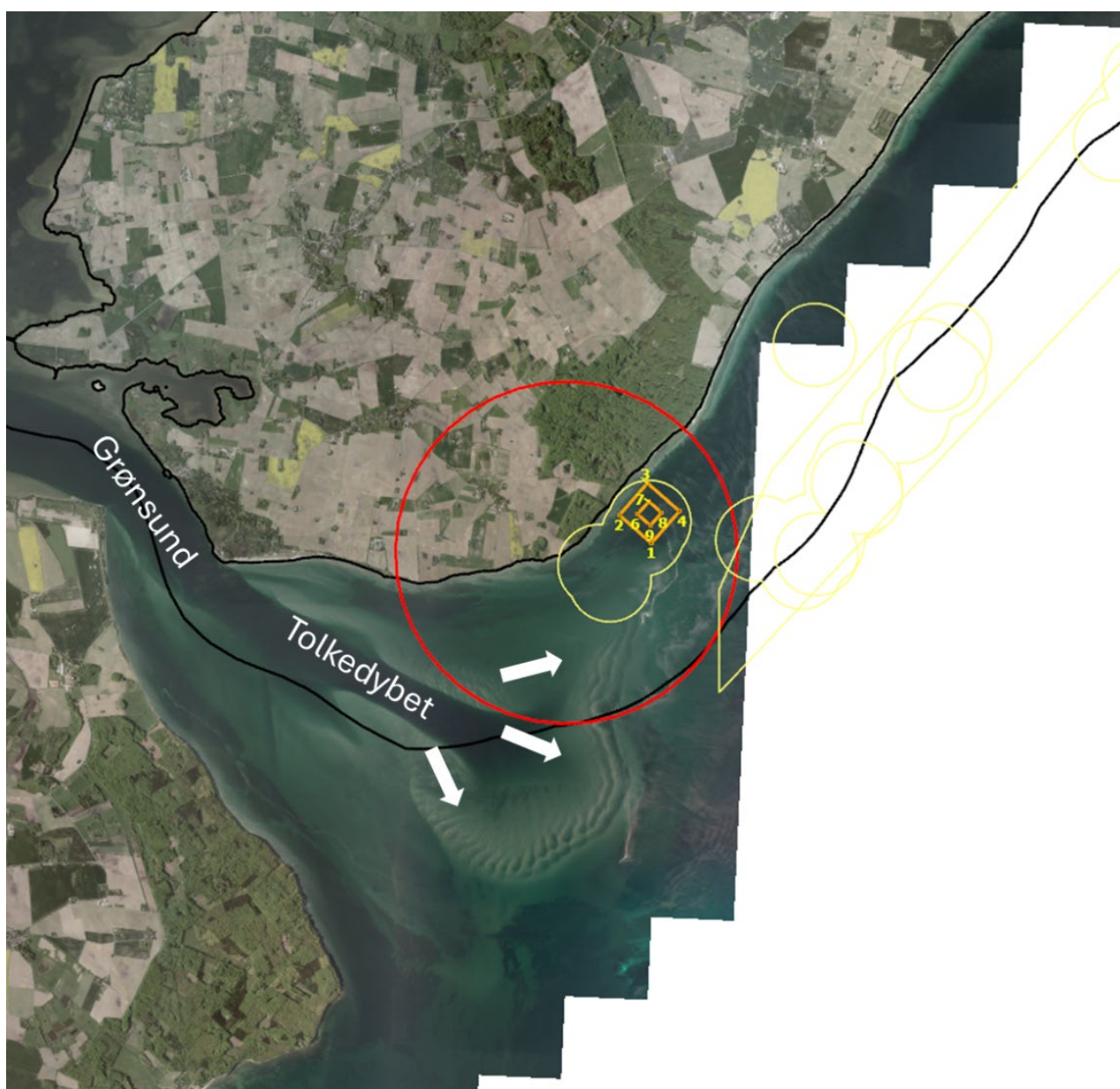
Figur 4.1. Indtegning af lokalområdet ved Madses Klint på et sommer ortofoto, hvor pilene angiver sandvandring. De orange firkanter markerer et område på 200x200 m (lille firkant) og 500x500 m (stor firkant). Disse områder afgrænser områder som det anbefales at arbejde videre med ifbm. de nødvendige opfølgende forundersøgelser. Tallene angiver placering af punkter til udlægning af bøger. Koordinater fra disse punkter blev anvendt af lokale dykkere til at markere undersøgelsesområdet. De gule polygoner viser områder, hvor der er dokumentation for tidligere stenfiskeri baseret på Petersen et al. (2024).
