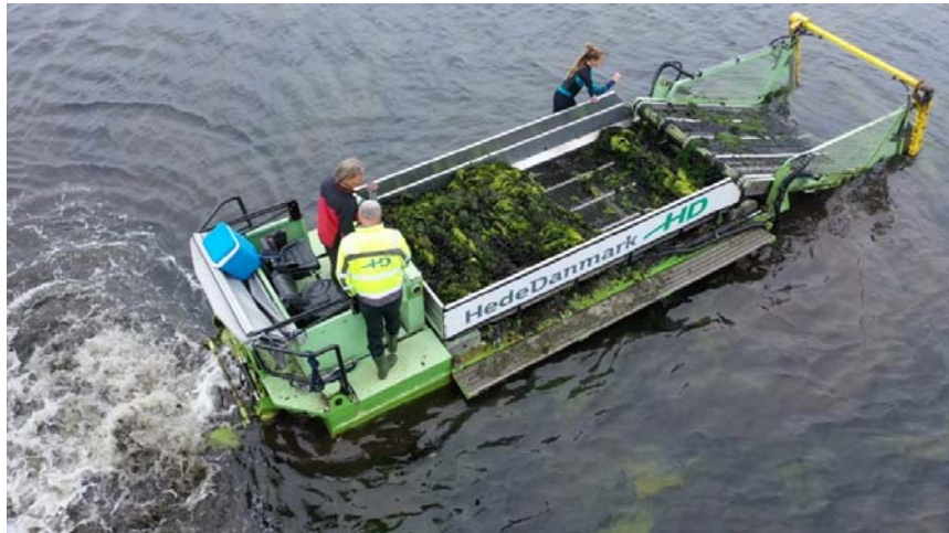
Figur 1. Sejlende høst af søsalat i Skive Fjord, august 2019. Båden bruges normalt til høst af grøde i lavvandede søer. Foto: Michael Bo Rasmussen.
