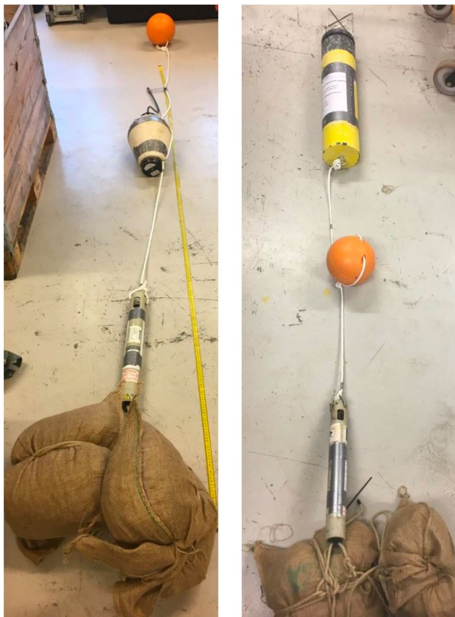
Figur 4.2. Eksempel på opsætningen af de to typer af målestationer. Venstre: Opsætning med ST500/ST600 dataloggere. Højre: Opsætning med SM2M dataloggeren.
