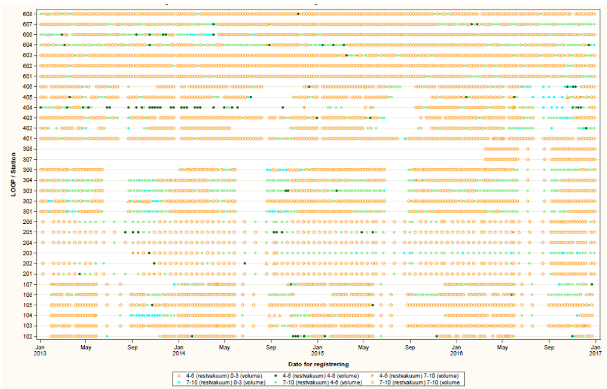
Figur 6 Oversigt over frekvens af sugeceller med restvakuum > 0,1 bar og opsamlet volumen >=40 ml på hver jordvandsstation i perioden 2013-2016.
