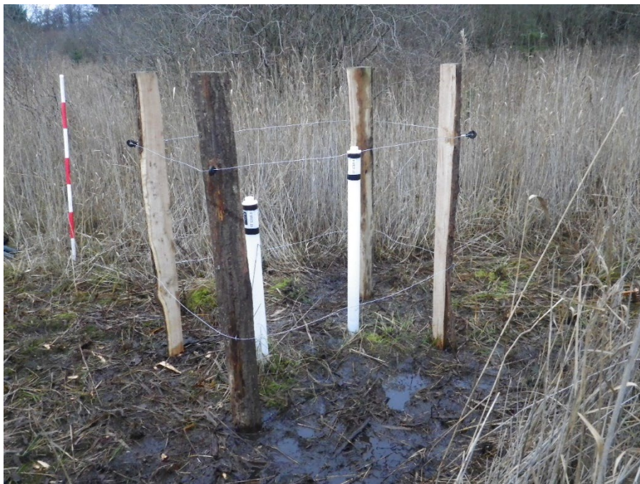
Figur 3. Vandstandsør og indhegning af det gode prøvefelt på Hærup Sø lokaliteten (foto: Henriette Bjerregaard, Miljøstyrelsen).
