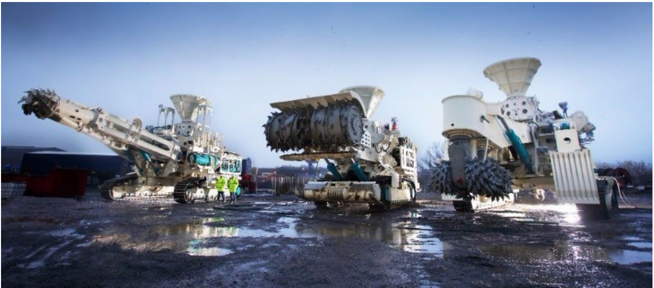
Figur 3. Eksempler på udvindingsmaskiner der er designet til udvinding af Sulfider. Fra venstre mod højre: Transportkøretøj, Primær Cutter og Auxillary Cutter (OSPAR Commission, 2021). Originalt billede fra Soil Machine Dynamics.
