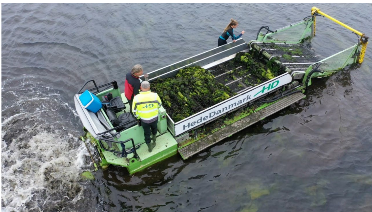
Figur 4. Skånsom høst af søsalat sommeren 2019 med HedeDanmarks grødehøster i regi af projektet SeaSusProtein (GUDP). Foto: Michael Bo Rasmussen.
