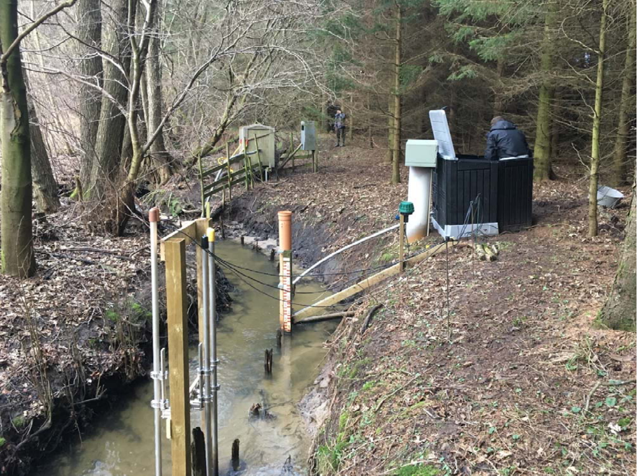
Figur 3. Opsætning af Nitratax sensoren i vandløbet Saltø Å (øverste og i Horndrup Bæk i et rack sammen med 2 andre sensorer (turbiditet og ledningsevne).
