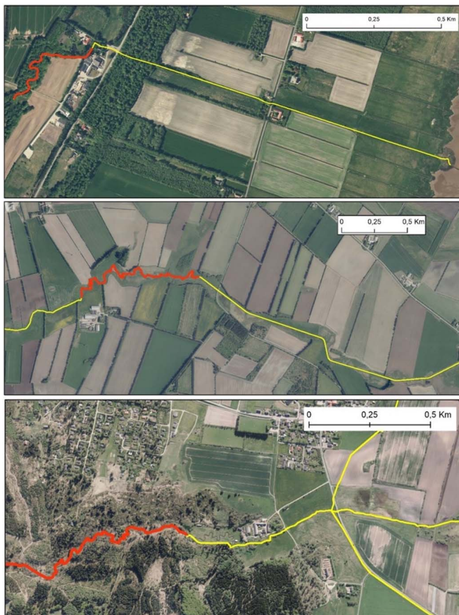
Figur 6. Tre eksempler på vandløbssegmenter, der både består af stærkt slyngede strækninger (vist med rødt) identificeret med den nye beregningsmetode, og mindre slyngede strækninger (vist med gul). De tre vandløbssegmenter er ikke medtaget i den eksisterende slyngningsproxy i Biodiversitetskortet, fordi de fulde segmentforløb ikke er tilstrækkeligt slyngede.
