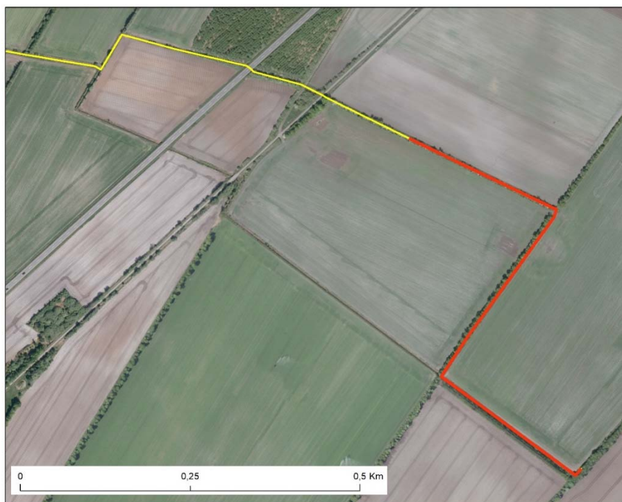
Figur 7. Viser et vandløb med såkaldte falske slyngninger i form af næsten vinkelrette, kanaliserede knæk.
