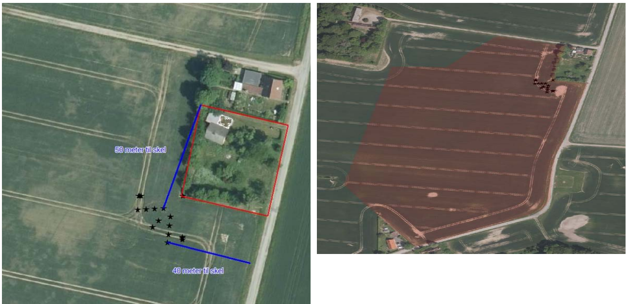
Figur 5. Sugecellers placering og rød markering af areal som er lagt til marken (tv) og markering af sugecellerr og drænoiland (brun farve) for samme mark (th).
