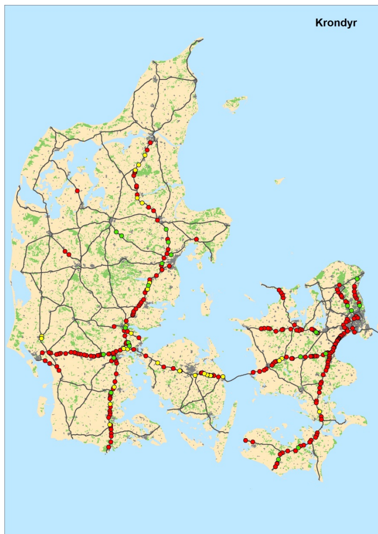
Figur 5. Passagemuligheder for kronstyr på motorveje og motortrafikveje, samt muligheder for at forbedre passagen. ●: ingen passage, ●: ingen passage, men passage kan etableres og ●: passage, som evt. kan forbedres (Møller m.fl. 2012).
