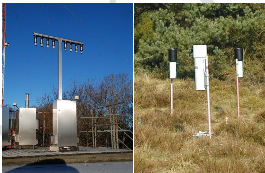
Figur 1.2. Eksempler på udstyr på målestationerne. Til venstre: Filterpackopsamler til opsamling af luftprøver. Opsamleren består af en filterholder (for enden af hver af de otte arme) med tre filtre, som luften suges igennem, hvorved partikler og gasser opsamles og separeres. Til højre: Nedbørsopsamlere til bestemmelse af bulkdeposition (dvs. våddeposition plus et lille bidrag fra tørdeposition). Nedbørsopsamlerne består af et stativ, en tragt og en opsamlingsflaske monteret forinden på tragten. Opsamlingsflasken er placeret i rør for at beskytte mod sollys.
