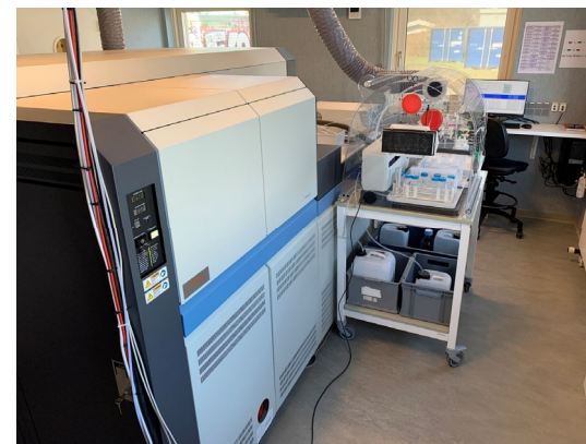
ECOS-AU's nye MC-ICP-MS instrument bevilliget af Carlsbergfondet til måling af bl.a. kviksølv-isotoper
