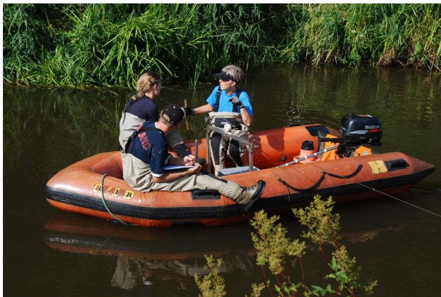
Figur 2.1. Gummibåd påmonteret specialbom til fastgørelse af den udspændte stålwire, der er fastgjort til hver vandløbsbred med jordspyd.
